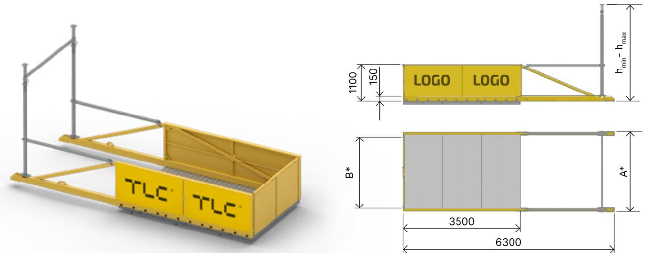
Plattformrahmen mit Füllung (Möglichkeit der Bedruckung mit Werbung)
