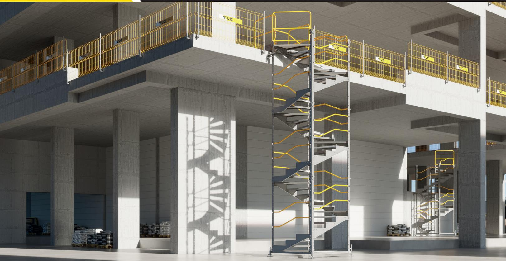
**Temporäre Spiraltreppe SST:** ein neues Produkt der TLC Group als eine zusätzliche und alternative Lösung zu temporären Treppen und Treppenhäusern des TAS Systems. Die Treppe findet auf Baustellen ihren Einsatz und ermöglicht die Verbindung der einzelnen Geschosse im entstehenden Gebäude. Das System besteht aus einem Grundmodul, weiteren Aufsatzmodulen und Zugangsstufen oder Podesten. Die gesamte Konstruktion ist durch das Feuerverzinkungsverfahren nach **EN 12811** korrosionsgeschützt.
