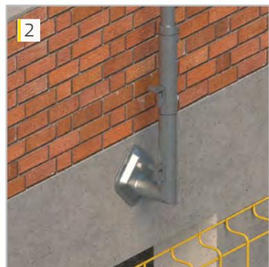
Vertikal verschraubte Halterung mit Verlängerung
